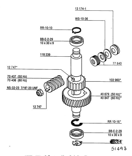
worm gear shaft, assembly (incl. items\*) 136 157-1 arbre roue hélicoidale, ensemble (compr. réf.\*) 50 Hz komplett Schneckenradwelle, (inkl. Teile\*) worm gear shaft, assembly (incl. items\*) 136 157-2 arbre roue hélicoidale, ensemble (compr. réf.\*) 60 Hz Schneckenradwelle, komplett (inkl. Teile\*)
